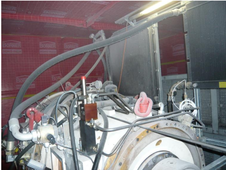
Bild 2: WinDrive und Kühler bei -35 °C
