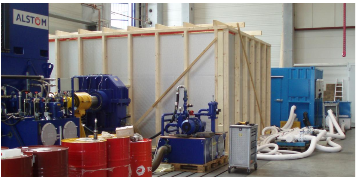
Bild 1: Prüffeld mit isoliertem WinDrive und Kühlaggregat
